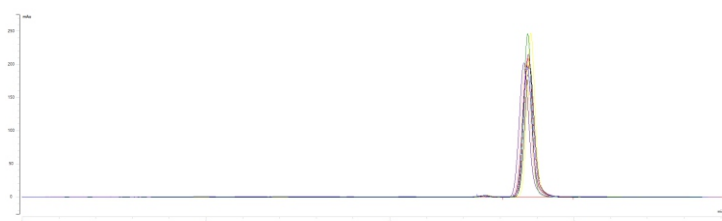
Эффективность колонки при многократной загрузке гибридного сорбента XP
